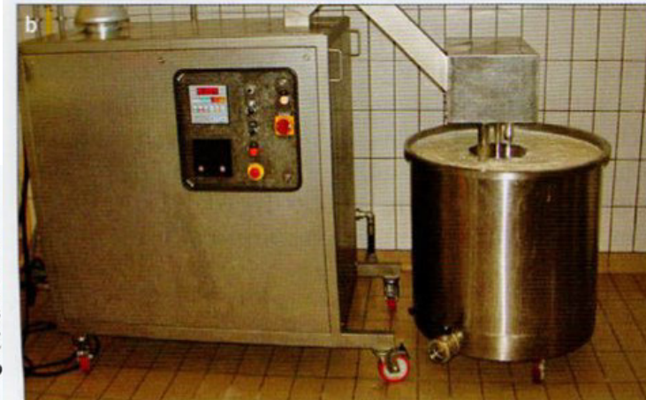
Fig. 8.22 – Impianto “Poly-food” per minicaseificio: il gruppo tubiero a turbina, per il riscaldamento del latte e/o della cagliata, è collegato al generatore di vapore e può essere calato in qualsiasi recipiente.
